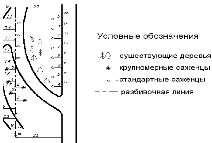
Пример посадочного чертежа на часть объекта озеленения.
